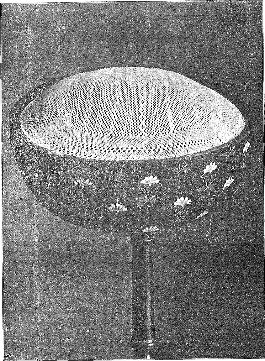
Fig. 17. Rutenischer Flechtapparat für Haubendeckel.
